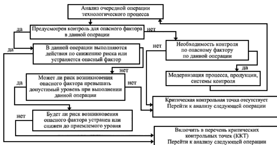
Рис.4. Метод "Дерево принятия решений" для определения критических контрольных точек
